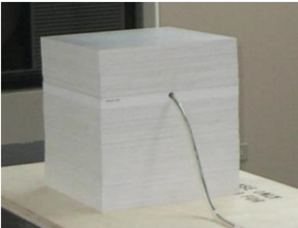
Figura 3: Instrumentos de medida del ISP: Fantoma de RW3 con la cámara de ionización
