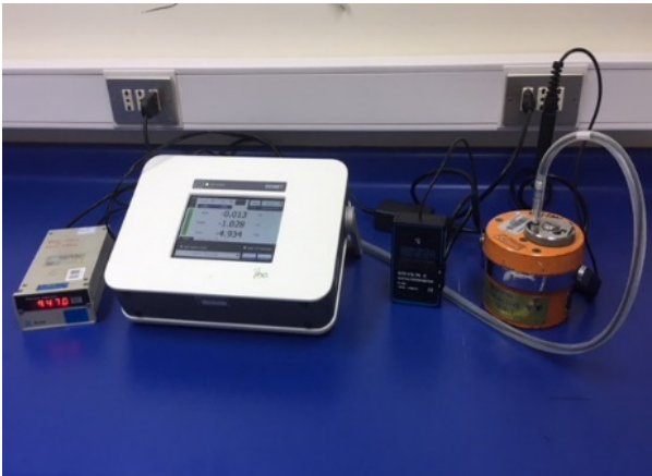
Figura 2: Instrumentos de medida del ISP: Cámara de ionización, electrómetro, termómetro y barómetro
